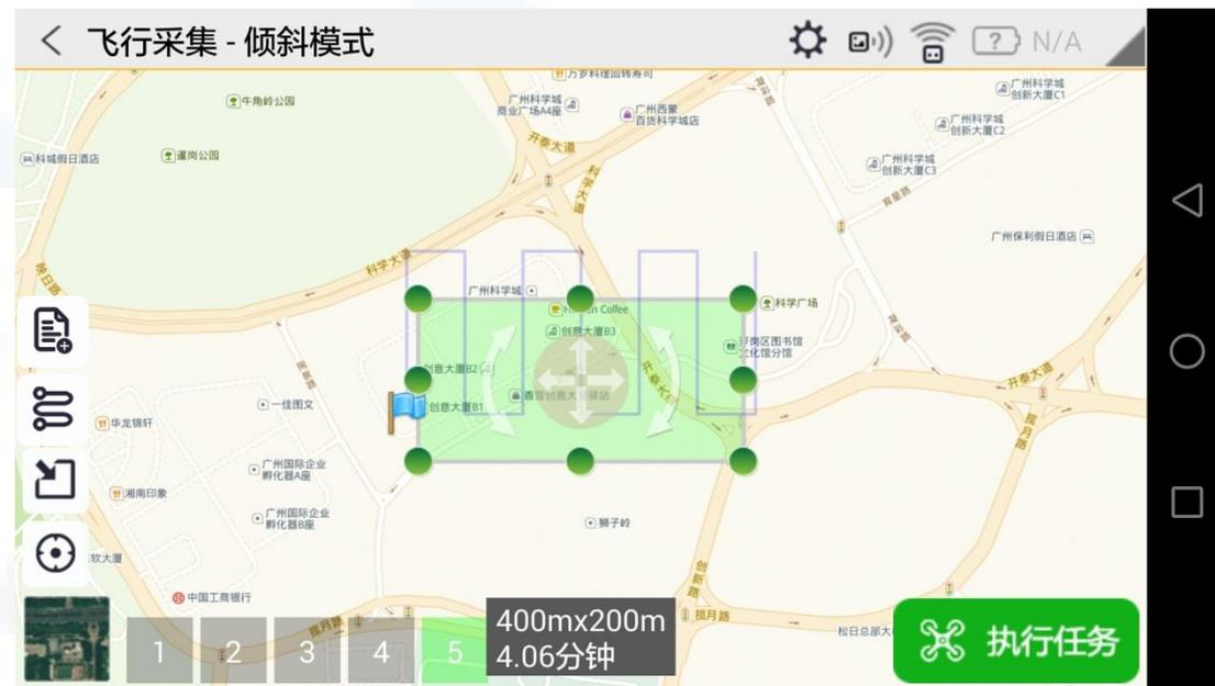
摄像镜头呈倾斜模式拍摄，通过对同一区域的5个不同的角度进行拍摄，可得到这一区域三维立体图。
